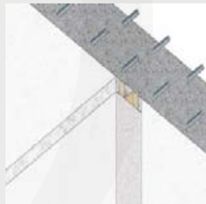
GIUNTO SOLAIO/PARETE Resistenza al fuoco: EI 240
