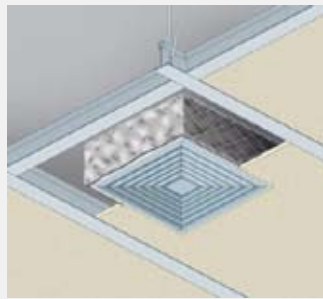
PROTEZIONE "GB-AIR" Resistenza al fuoco: REI 120
