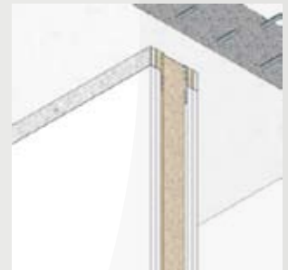
GIUNTO PARETE LEGGERA Resistenza al fuoco: EI 120
