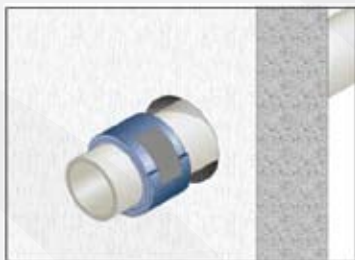
NASTRO TERMOESPANDENTE "GB-T"
