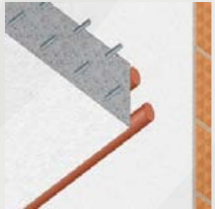
GIUNTO PARETE/SOLAIO Resistenza al fuoco: EI 120
