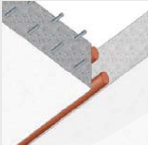
GIUNTO SOLAIO/SOLAIO Resistenza al fuoco: EI 120
